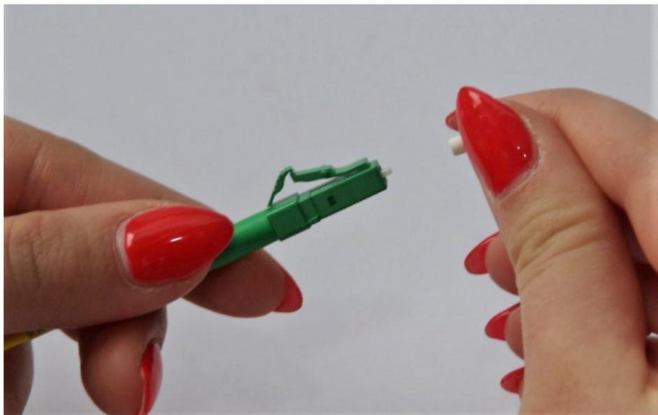
Die Staubschutzkappe vom Kabelstecker entfernen.
