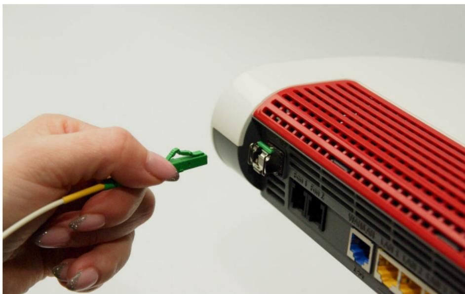
Den Stecker in die Glasfaserbuchse stecken (Knackgeräusch).
