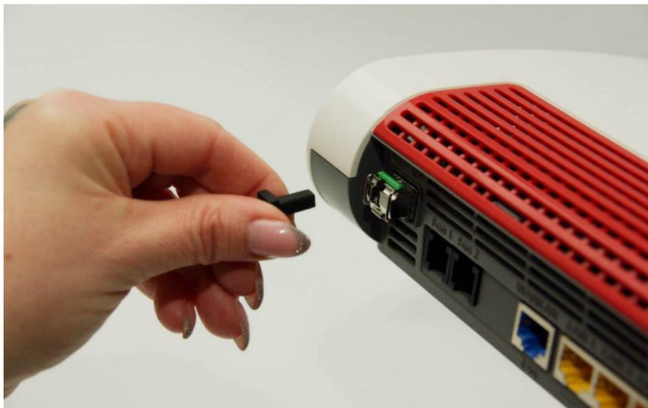
Die Staubschutzkappe von der Glasfaserbuchse der FRITZ!Box entfernen.
