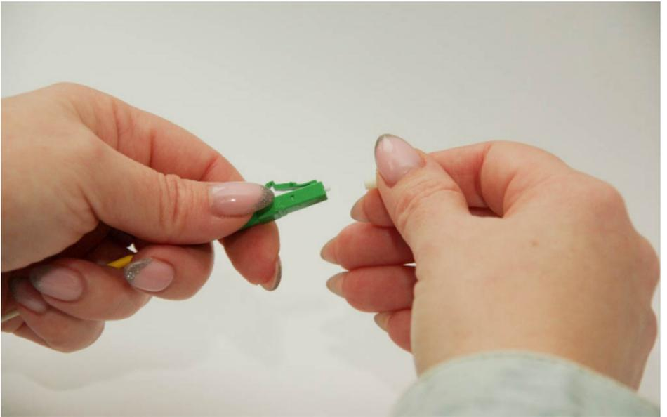
Die Staubschutzkappe vom Kabelstecker entfernen.
