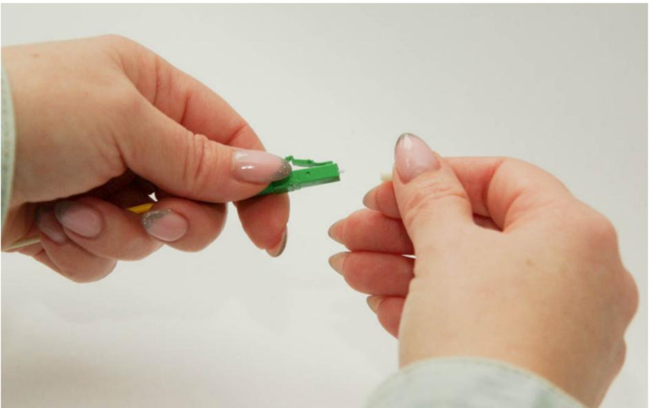
Die Staubschutzkappe vom anderen Kabelstecker entfernen.
